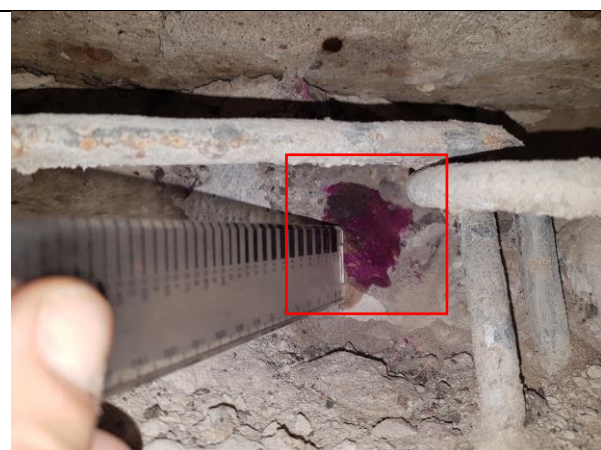
3.1.3.att. Pagraba nesošās dzelzsbetona sienas. Karbonizētais slānis lielāks par 1,0 cm.
