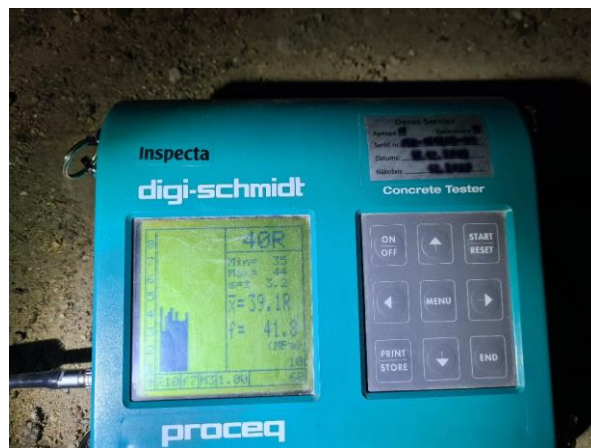
2.20.att. Rezultāts 41,8 MPa, ar karbonizācijas pakāpi D=6 rezultāts 26 MPa. Atbilst.
