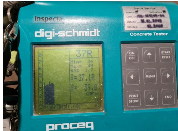
2.10.att. Rezultāts 39,0 MPa, ar karbonizācijas pakāpi D=6 rezultāts 24 MPa. Atbilst.
