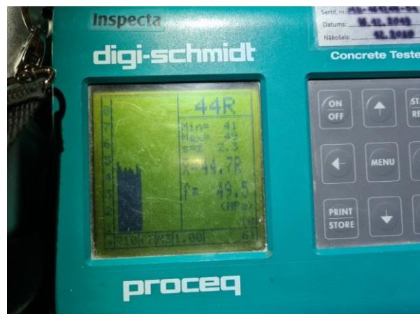
2.6.att. Rezultāts 49,5 MPa, ar karbonizācijas pakāpi D=6 rezultāts 30 MPa. Atbilst.
