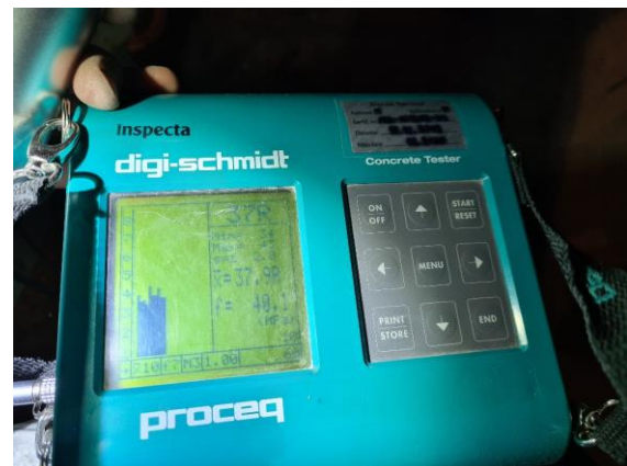
2.4.att. Rezultāts 40,1 MPa, ar karbonizācijas pakāpi D=6 rezultāts 25 MPa. Atbilst.
