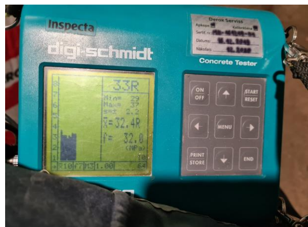
2.12.att. Rezultāts 32,4 MPa, ar karbonizācijas pakāpi D=6 rezultāts 20 MPa. Atbilst.
