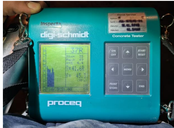
2.2.att. Rezultāts 45,3 MPa, ar karbonizācijas pakāpi D=6 rezultāts 28 MPa. Atbilst.
