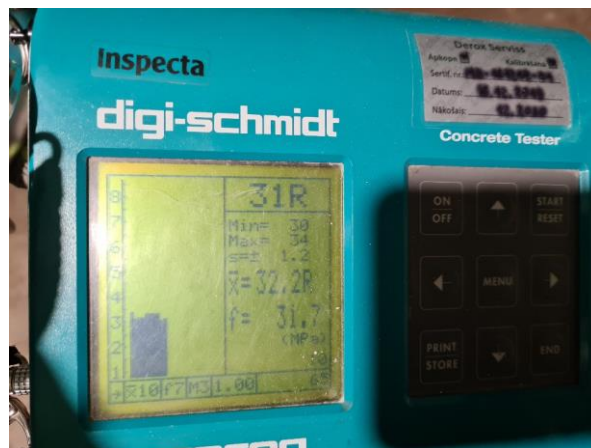
2.14.att. Rezultāts 31,7 MPa, ar karbonizācijas pakāpi D=6 rezultāts 20 MPa. Atbilst.
