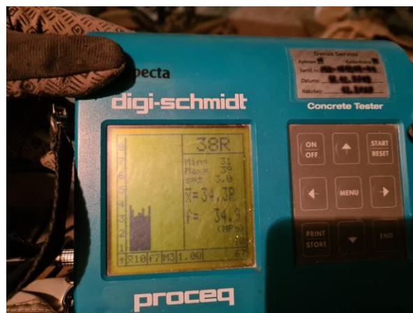
2.18.att. Rezultāts 34,9 MPa, ar karbonizācijas pakāpi D=6 rezultāts 21 MPa. Atbilst.
