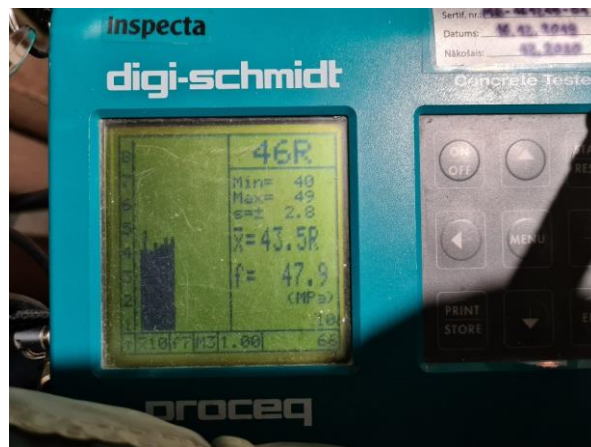
2.16.att. Rezultāts 47,9 MPa, ar karbonizācijas pakāpi D=6 rezultāts 29 MPa. Atbilst.
