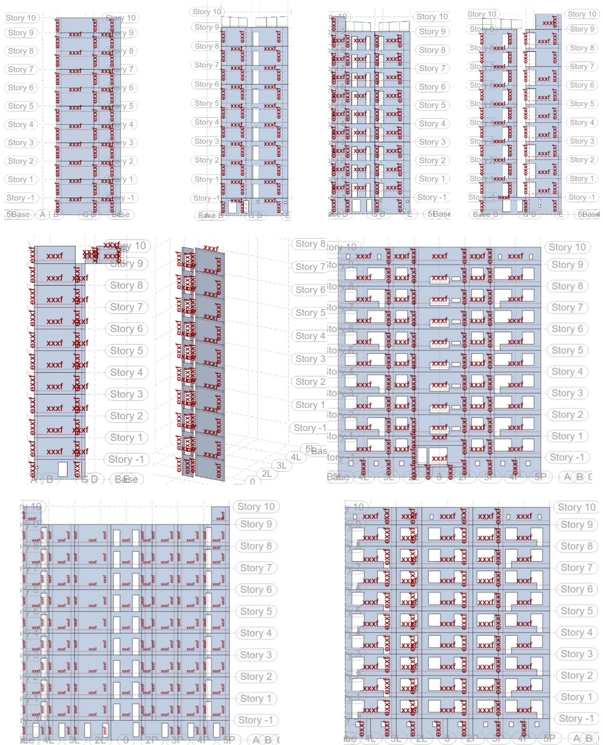
18.att. Locīklu definēšana sienām, kur xxxf – lineāra locīkla, exxf – lineāras locīklas ar bīdes stingumu
