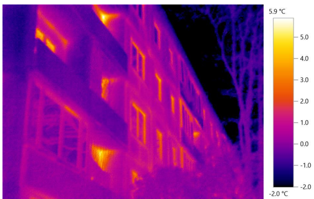
11.attēls. Ēkas fasāde, ārsienas/balkona termiskais tilts
