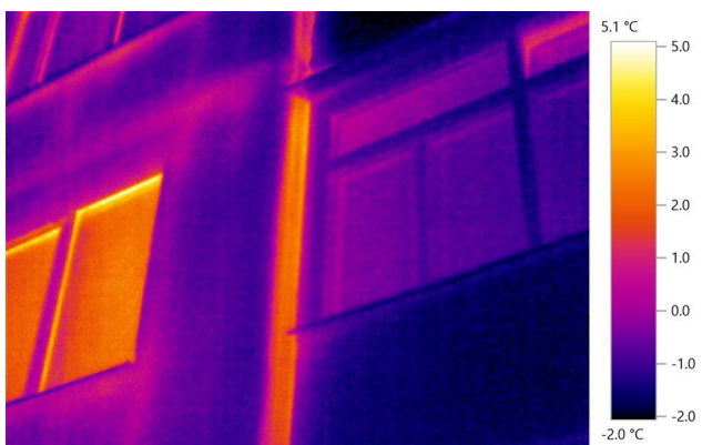
12.attēls. Termiskais tilts, paaugstināta virsmas temperatūra loga rāmja/stiklojuma savienojuma vietā
