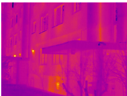
11.attēls. Paaugstināta virsmas temperatūra uz koka konstrukcijām kāpņu telpā
