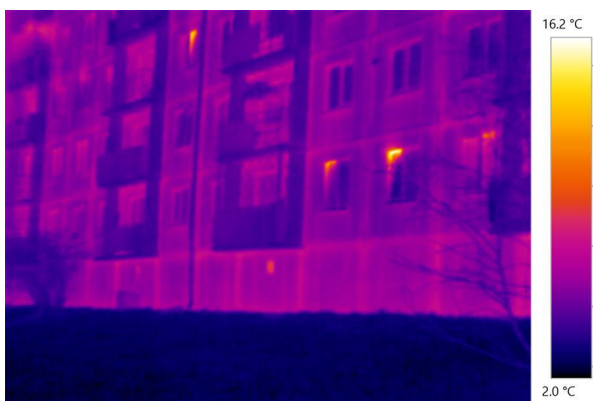
10.attēls. Paaugstināta virsmas temperatūra balkona/ārsienas mezglā
