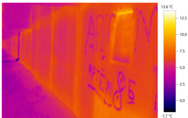
9.attēls. Virsmas temperatūras paaugstināšanās cokola paneļu šuvju vietās
