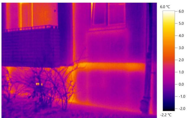
11.attēls. Paaugstināta virsmas temperatūra cokola/ārsiena mezglā
