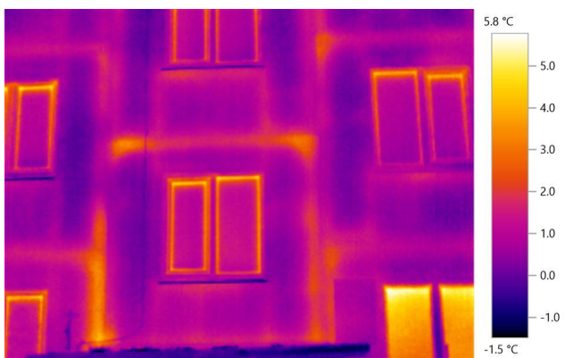
18.attēls. Paaugstināta virsmas temperatūra paneļu savienojuma vietās
