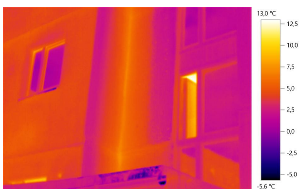
11. att. Ēkas stūris kāpņu telpā (termiskais tilts)
