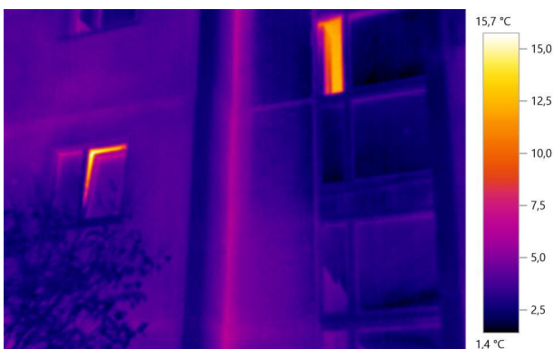
2. att. Termiskais tilts ēkas iekšējā stūrī
